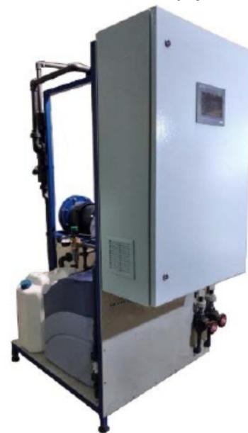
Передбачається реконструкція системи знезараження води з переходом на використання сучасної електролізної установки з виробництва та дозування подачі гіпохлориту натрію. Установка з виробництва гіпохлориту натрію значно безпечніша, а застосування насосу-дозатора покращує ефективність використання гіпохлориту натрію.
